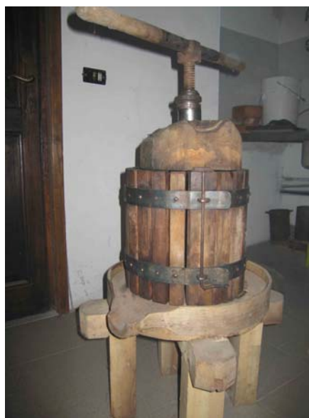
Fig. 16 – Macina e torchio da noci utilizzati per l'oleificazione dalla famiglia Gilardi di Pila
